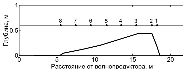
Рис. 1. Схема эксперимента. Цифры над поверхностью - номера волнографов
